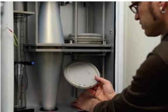
Rücknahme eines bestaubten PM10-Filters aus dem Probensammler. Der Probensammler fasst einen Vorrat von 14 Filtern. Die Filter werden automatisch gewechselt und während 24 Stunden bestaubt.
