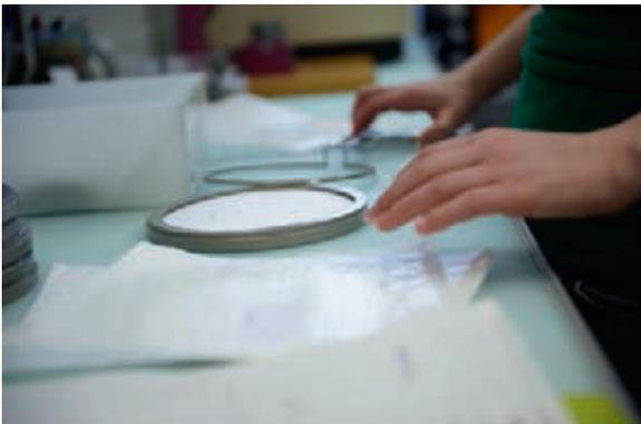
Vorbereitung eines PM10-Filters für den Einsatz in einem High Volume Sampler. Das Gewicht der PM10-Filter wird im Labor unter konditionierten Bedingungen vor dem Bestauben gewogen.
