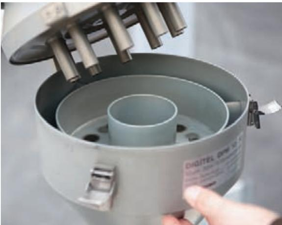
Dank des speziellen Ansaugkopfes gelangen nur Staubteilchen mit einem Durchmesser von weniger als 10  $\mu\text{m}$  durch die Abscheidedüsen und weiter durch das Ansaugsystem auf den Filter. Größere Teilchen bleiben auf einer Prallplatte im Ansaugkopf haften.
