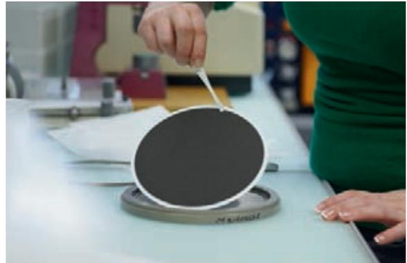
Je nach PM10-Belastung sind die Filter nach 24 Stunden Bestäubung unterschiedlich geschwärzt. Je dunkler der Filter ist, desto grösser ist die PM10-Konzentration. Die schwarze Farbe des Staubes deutet auf einen hohen Dieselmotorenanteil hin, schwarzbraune Filter weisen auf einen grossen Holzfeuerungsanteil hin.
