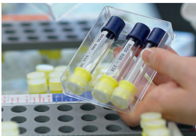
Handgriffe zur Vorbereitung von Luftschadstoffmessungen (von links nach rechts: Filter eines Feinstaub-Messgerätes, beschichtete Netzen für die NO 2 -Passivsammler, Verpacken der NO 2 -Passivsammler).
