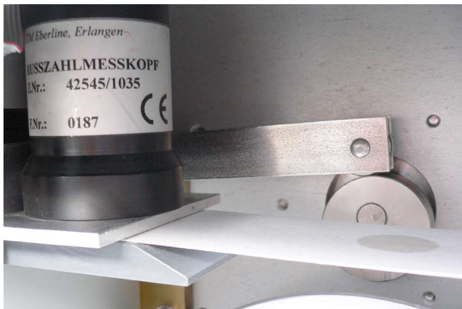
Russmesskopf und Filterband mit bestäubtem Fleck
