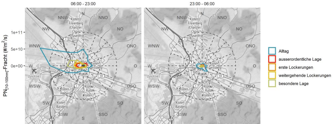
Abbildung 20: Mittlere PN_{[10-100nm]}\text{-Fracht} (Produkt von PN_{[10-100nm]} und Windgeschwindigkeit) nach Windrichtung, Tageszeit (Lokalzeit) und Covid-Phasen.
