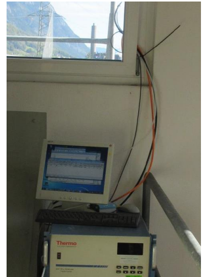
Abb. 6 kontinuierliches SO 2 Messgerät
