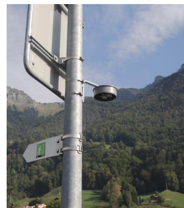
Abb. 4 SO 2 Passivsammler mit Wetterschutzhaube
