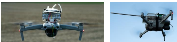
Abb. 16 Feinstaubdrohne von vorne (links), und von der Seite mit Luftansaugung (rechts).
