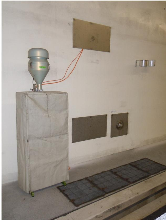
Abbildung 9 HiVol-Samplers und Passivsammler im Fahrraum des Islisbergtunnels beim Ausfahrtsportal in Wettswil a. A.
