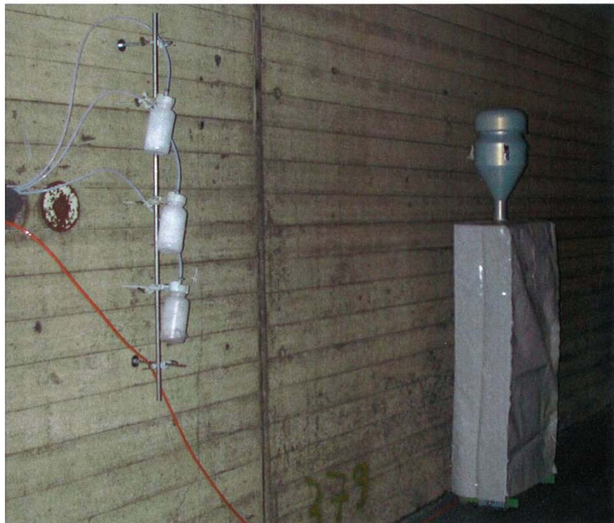
Figur 1.1 HiVol-Sampler und Ansaugfilter für NO x , CO und TVOC 10 m vor dem Ausfahrtsportal Regensdorf
