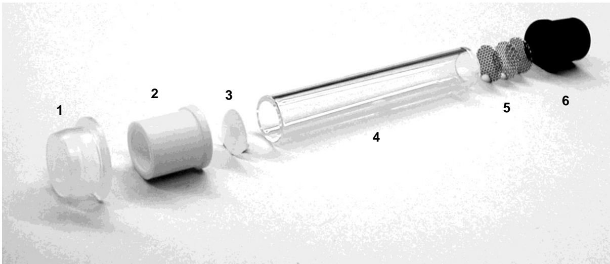
Abbildung 1: Aufbau Passivsammler. 1. Verschlusskappe aus PE, 2. +3. Windschutz (PE Kappe mit Teflonmembran) 4. Kunststoffrohr aus PMMA, 5. Chromstahlnetze, 6. PE Kappe
