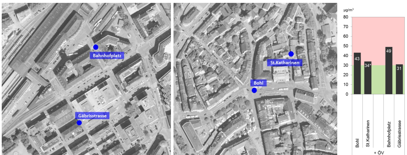
Abb. 2: Passivsammler-Standorte im Bereich von Knoten des öffentlichen Verkehrs (öV) im Zentrum der Stadt St.Gallen und die zugehörigen NO 2 -Jahresmittelwerte [ \mu\text{g}/\text{m}^3 ]
