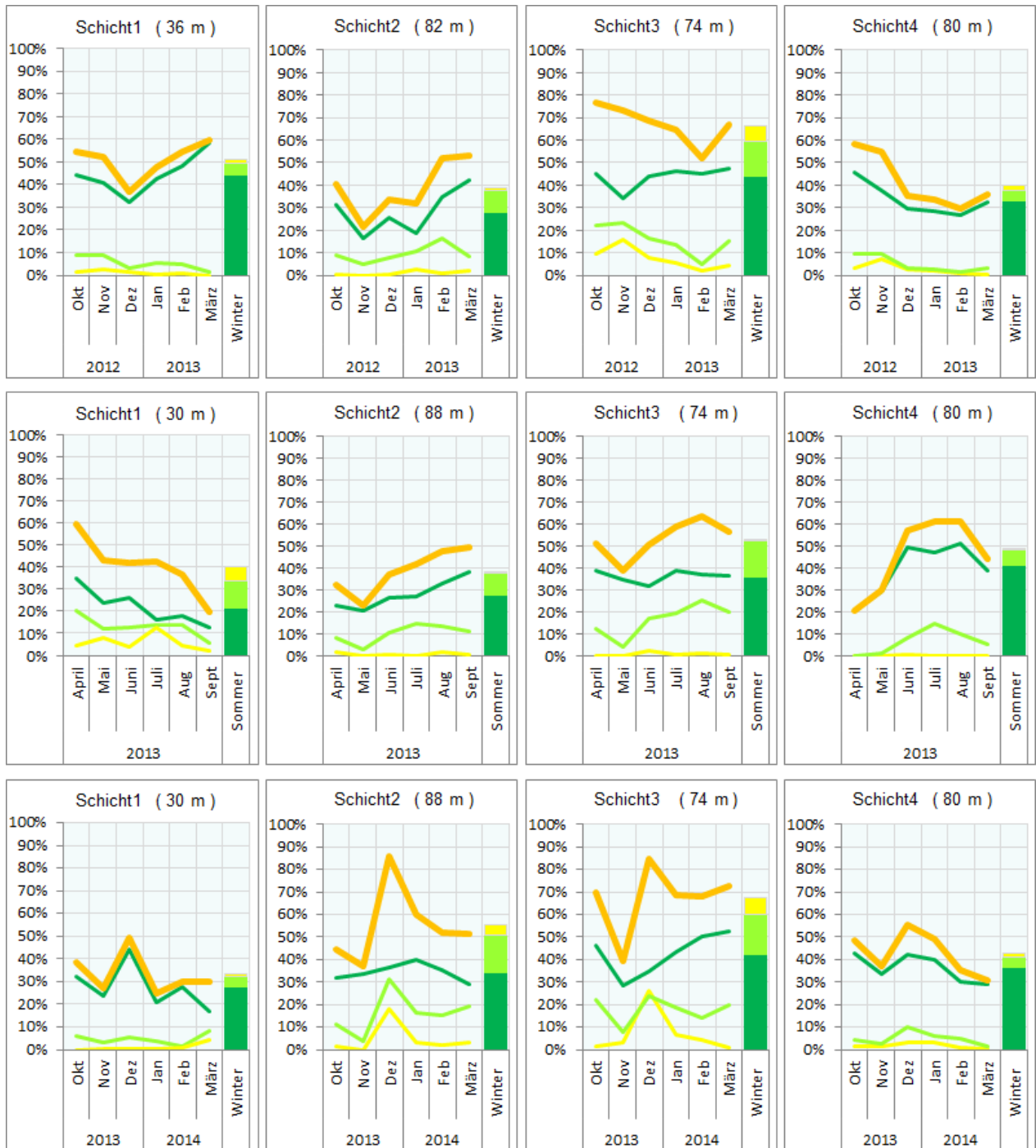
Abb. 36: Inversionshäufigkeit in Prozent je Schicht und Inversionsstärke (Summe aller Inversionen = orange) unterschieden nach Monat und total Winter
