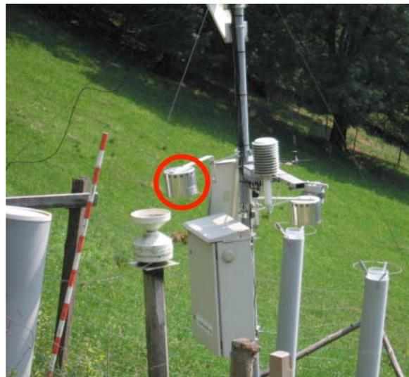
Die Passivsampler sind am Meteomasten angebracht
