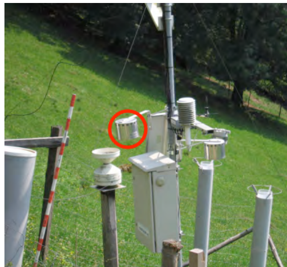
Die Passivsampler sind am Meteomasten angebracht
