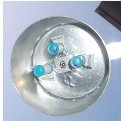
Abb. 6.2 a) Schema des Radiello Passivsammlers, Gesamtlänge 65 mm mit Schutzbüchse, die gleichzeitig als Aufhängevorrichtung dient.
